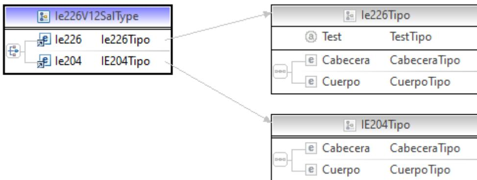
En la definición de este servicio se describe que el mensaje de entrada se basa en el esquema Ie226V12Ent.xsd, la respuesta cuando se acepta el envío de las notas de entrega y/o la reintroducción de un albarán en el esquema Ie226V12Sal.xsd y la respuesta cuando no es aceptada el envió en el esquema Ie204V1Sal.xsd.
