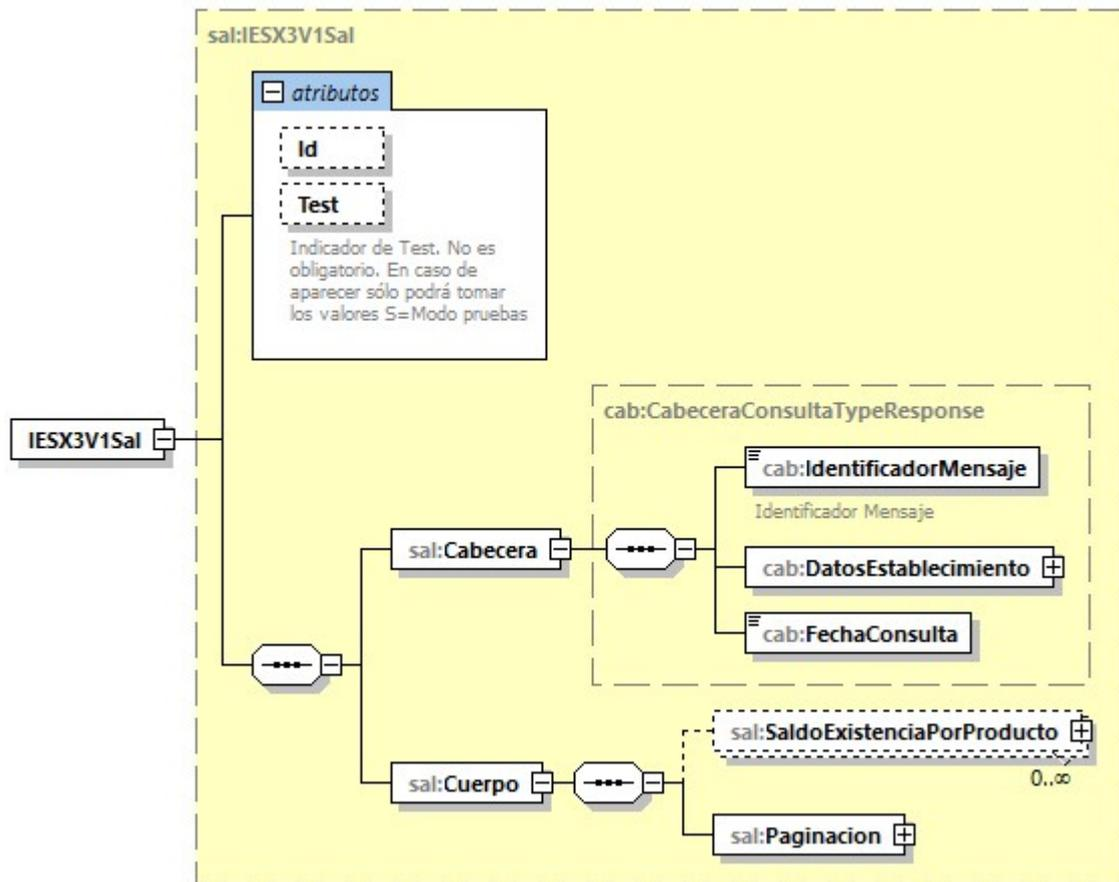
Figura 15: Estructura Básica Mensaje Salida
